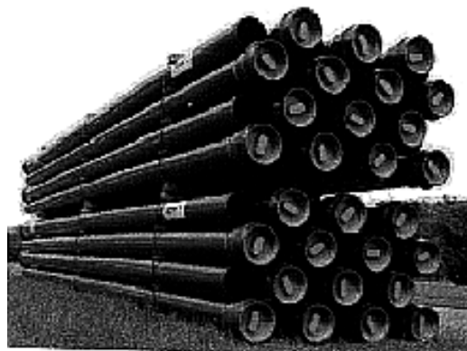
Figure 7: tubes PVC à joints collés PN 10
